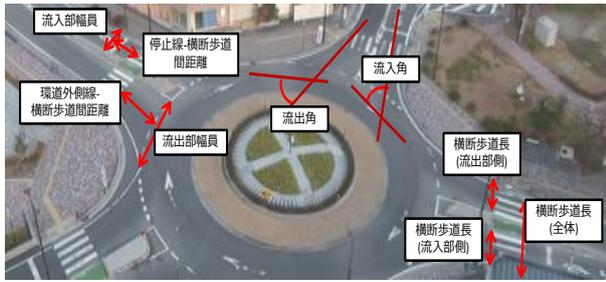
図-1 RAB 構造諸量計測基準
