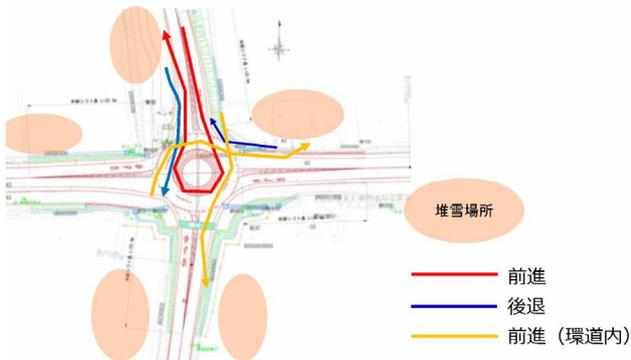
図-26 除雪ドーザの経路
