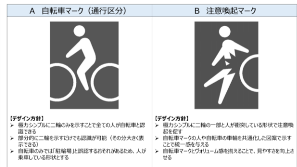
図-10 デザイン調整により決定した小型標識・ピクトグラム
