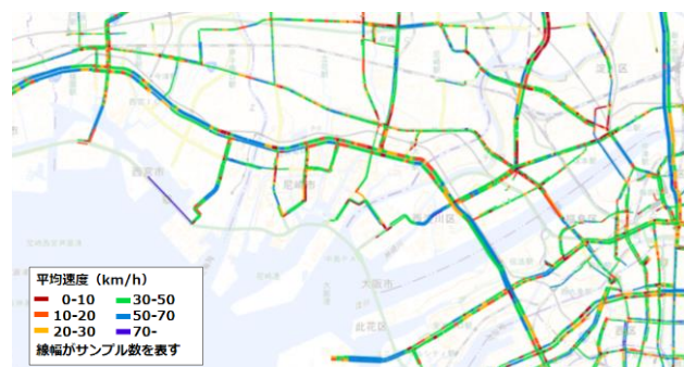
図-9 工事中の平均リンク旅行速度(一般道路)
