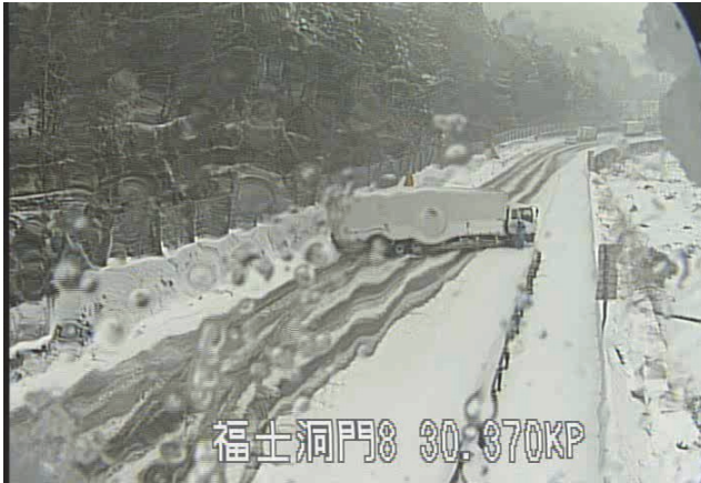
図-3 スタックの状況 (甲府河川国道事務所提供)
