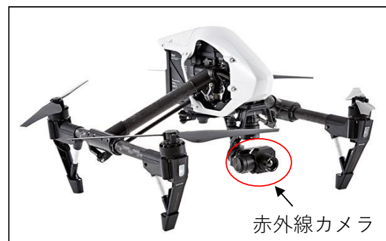
図-2 建物被害の撮影に用いた赤外線カメラを搭載した UAV 6)
