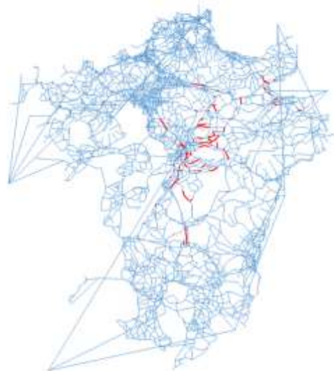
図-4 九州全域の通行止箇所（84箇所、地震直後）
