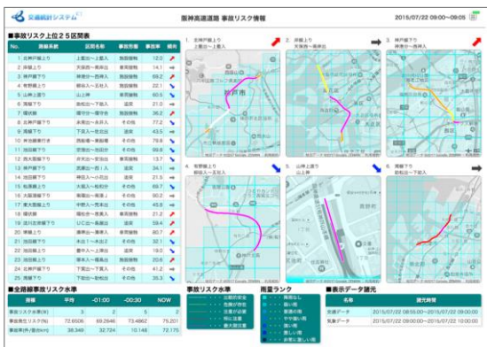
図-6 管制室に設置予定の事故リスク表示端末 画面例
