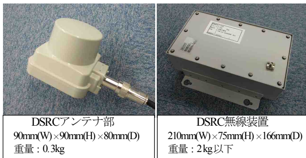
図-4 実験に使用した路側機
