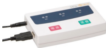
図-2 通信機器 (歩数計, 血圧計と繋ぎ, データ送信する)
