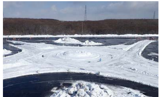
写真-2 模擬ラウンドアバウト堆雪状況 (撮影日：平成 28年 2月 11日)
