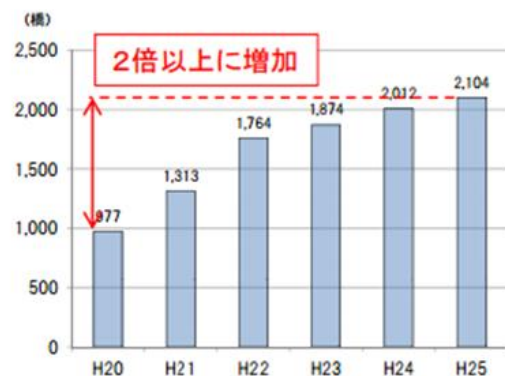
図-2 地方公共団体管理橋梁の通行規制等の推移 (2m以上) 2)
