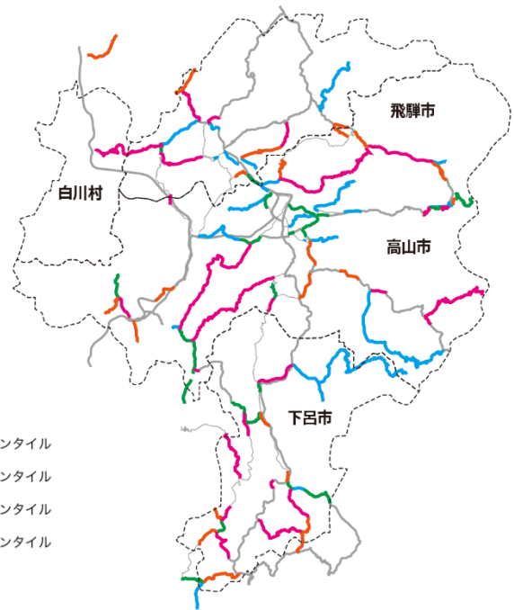
図-6 簡略法によって求めたリンク信頼度
