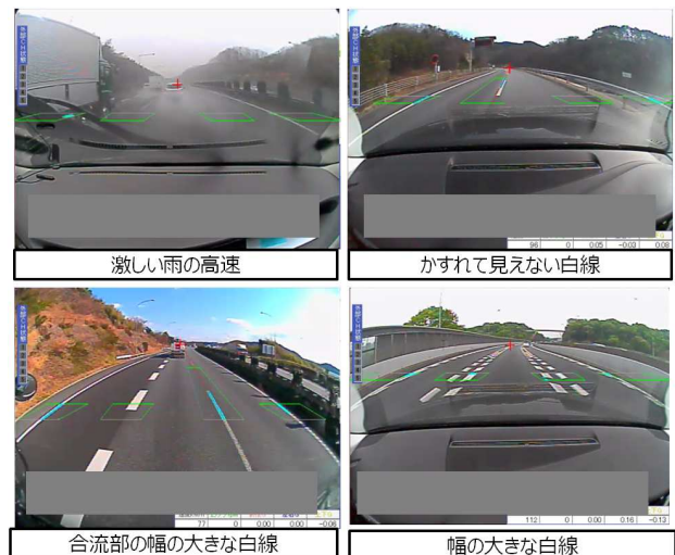
図-3 車線逸脱における走行車線の画像認識がしにくくなるケースの代表例
