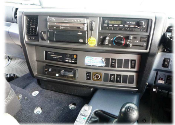
図-2 DTG7車載器の設置後の様子(車内)
