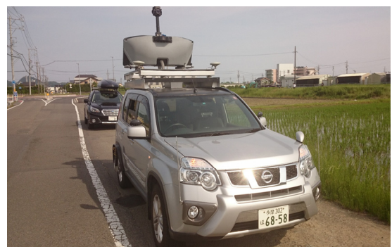
図-2 MMSを搭載した調査車両
