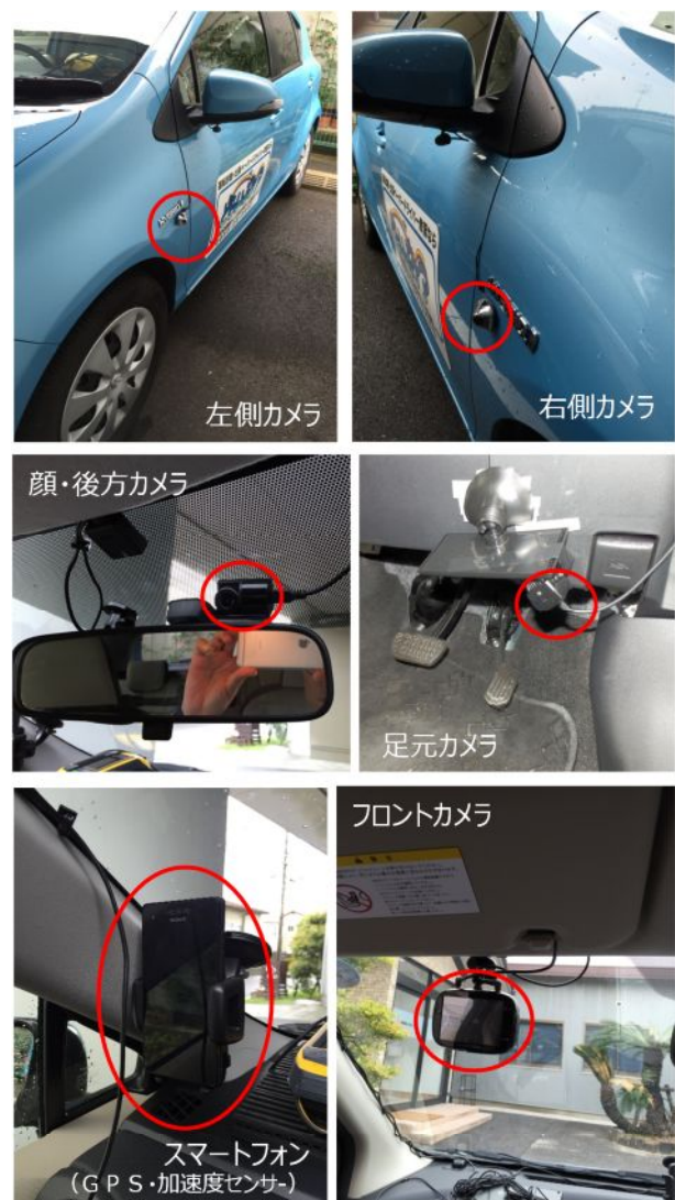
図-2 ドライブレコーダーとスマートフォンの設置
