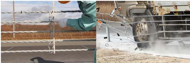
写真-14 CASE2 (左: ロープ連結材, 右: 衝突時の状況)
