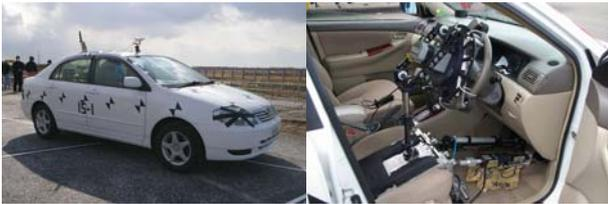
写真-20 試験車両（左：RTK-GPS、右：自動操舵ロボ）
