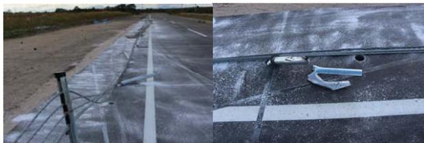
写真-9 衝突後の防護柵（左）と破断した支柱（右）
