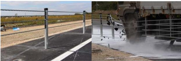
写真-8 ワイヤロープ式防護柵（左）と衝突時の状況（右）
