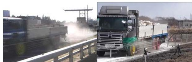
写真-23 大型車衝突状況（左：H23試験、右：H27試験）
