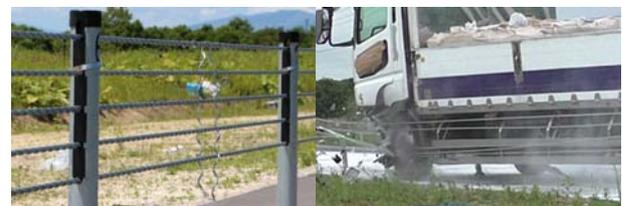
写真-17 CASE5 (左: 防護柵設置状況, 右: 衝突時の状況)
