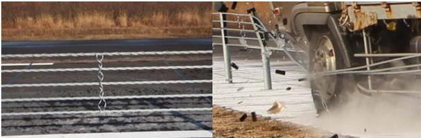
写真-15 CASE3 (左: ロープ連結材, 右: 衝突時の状況)
