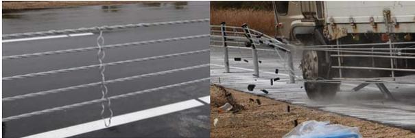
写真-13 CASE1 (左: ロープ連結材, 右: 衝突時の状況)
