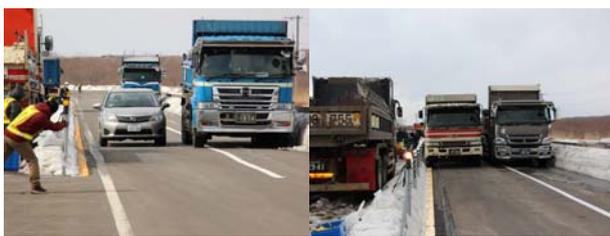
写真-6 走行試験の状況(左:乗用車,右:大型車)
