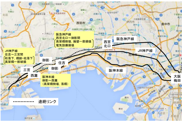
図-2a 阪神淡路大震災によって途絶したリンク (発災 2 ヶ月後)
