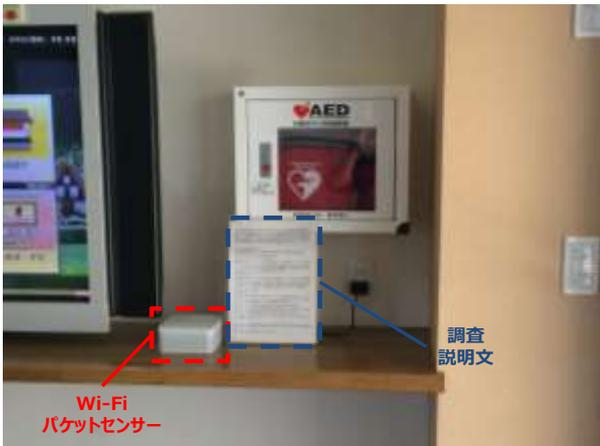
図-3 Wi-Fi パケットセンサーの設置例
