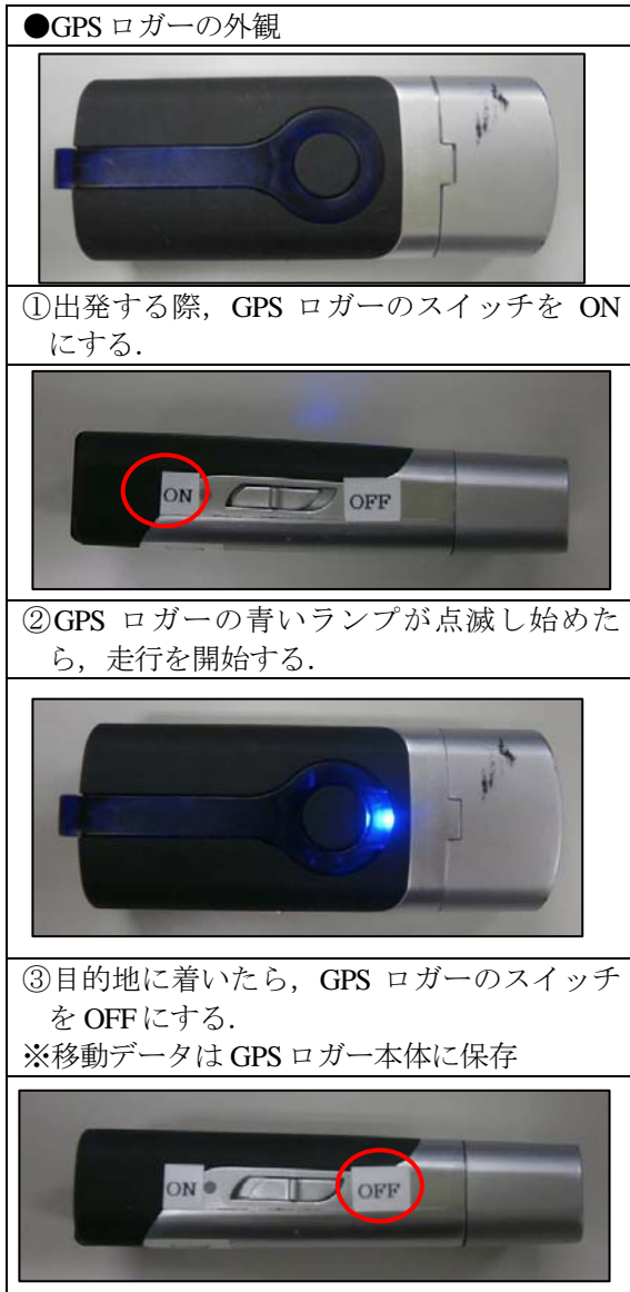
図-6 GPSロガーの使用方法
