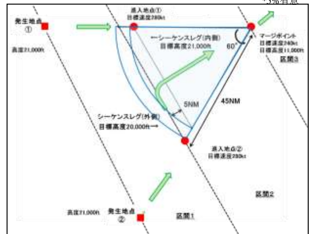
図-13. 実装したPoint Merge (矢印は航空機の流れを表す)
