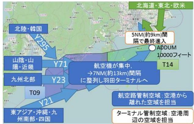
図1 羽田空港到着機の飛行経路(AIP<sup>12)</sup>より筆者作成)
