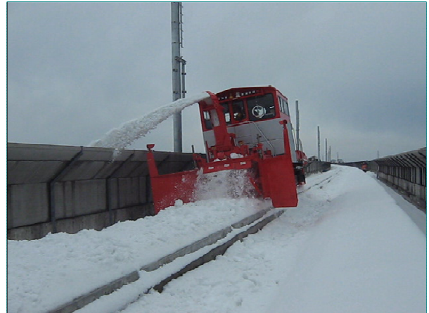
写-2 投雪状況(側方開床式高架橋)
