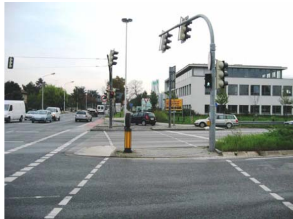
図-10 信号交差点における二段階横断(ドイツの例) *横断歩道が交通島で分割され、手前と奥で異なる歩行者信号表示
