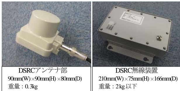
図-5 実験に使用した路側機
