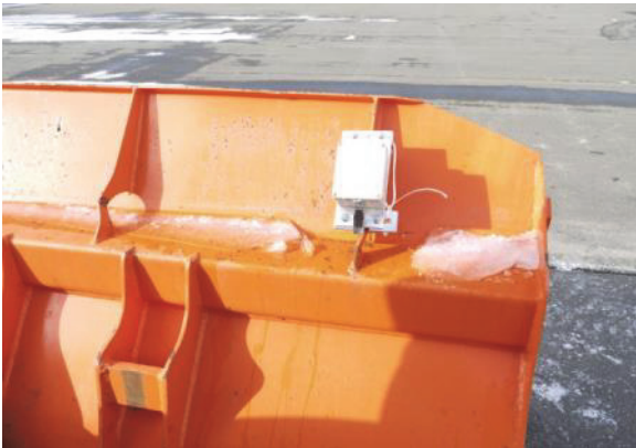
写真-5 加速度計の取付状況 (ホイールローダ)
