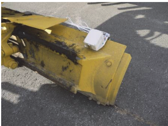
写真-6 加速度計の取付状況 (モータグレーダ)
