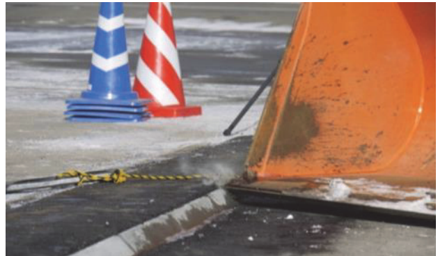
写真-7 バケットの接触状況 (傾斜角度45° , ホイールローダ)
