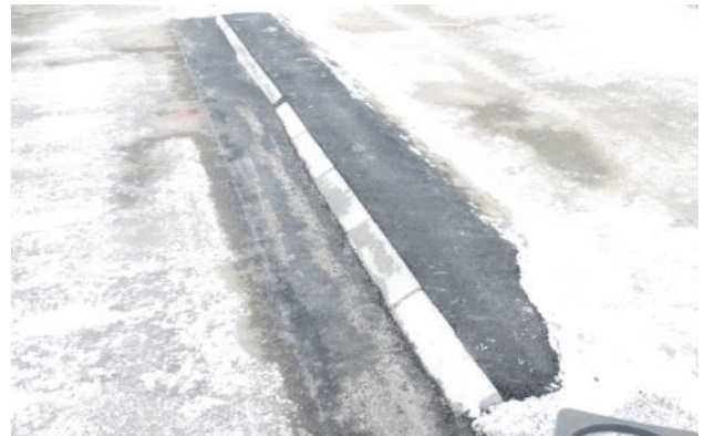
写真-2 すりつけ形状の模擬エプロン (傾斜角度30°、45°)
