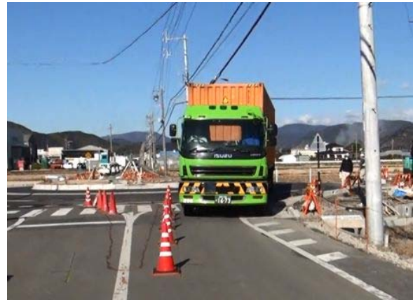
写真-2 セミトレーラの走行確認
