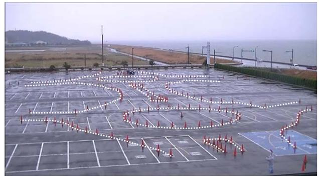
写真4 ダブルラウンドアバウトの模擬コース
