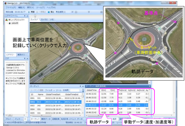
図-3 軌跡データ取得作業の例
