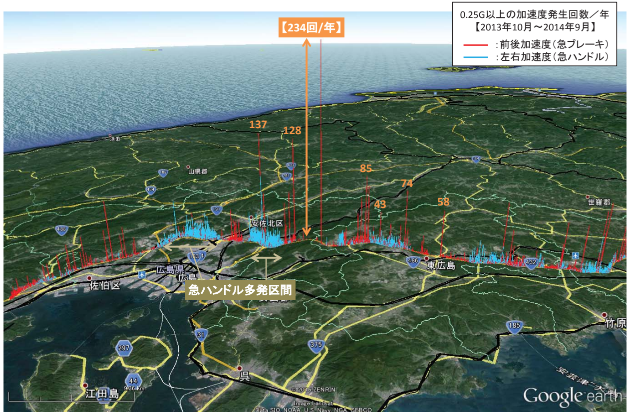
図-9 急加速の発生状況の例 山陽自動車道広島県周辺（下り方向）
