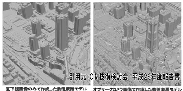
図-10 オブリークカメラによるモデル作成例
