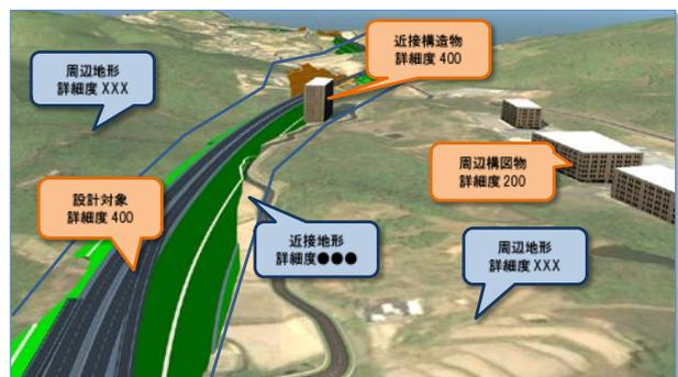
図-1 道路設計でのモデル内でのレベル混在の例
