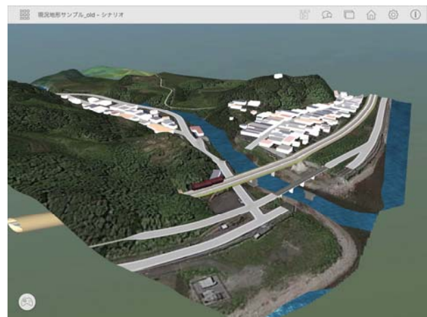
図-3 クラウド上に格納したモデルをiPadで表示した例
