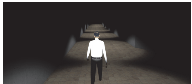
図9 非常用照明作動時の避難状況
