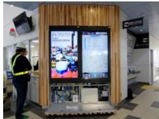
図 10 摩耶駅タッチパネル式 DS (右側) ※タッチパネル式 DS 下部にセンサーボックスを設置
