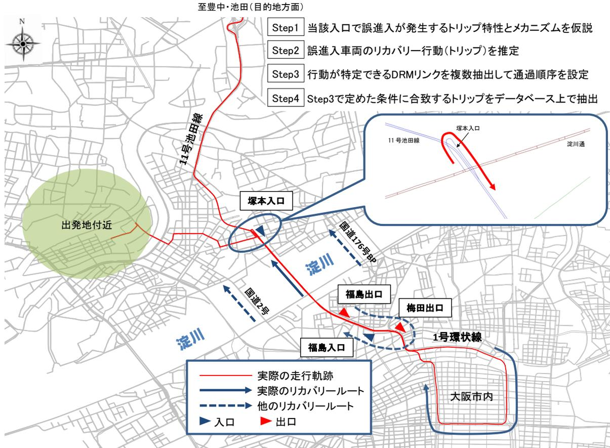
図-3 プローブデータを活用した誤進入事案抽出のイメージ（11号池田線（大阪市内方面）塚本入口での間違い例）
