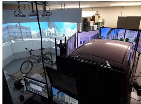
写真-1 自転車・自動車ドライビングシミュレータ
