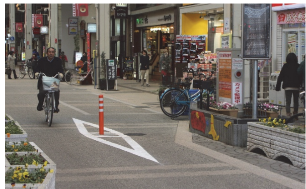
図-2 社会実験中のソフトライジングボラード(新潟市ふるまちモール6)
