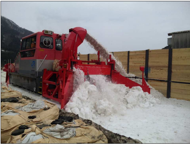
写-1 雪害機能確認試験状況
