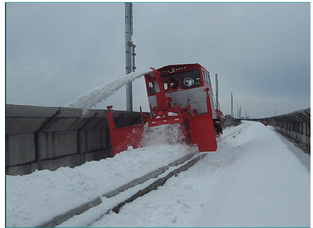
写-4 除雪試験状況（側方開床式高架橋）
