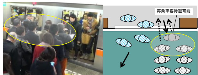
図-6 混雑に対する乗降時分の抑制策（表参道駅）
