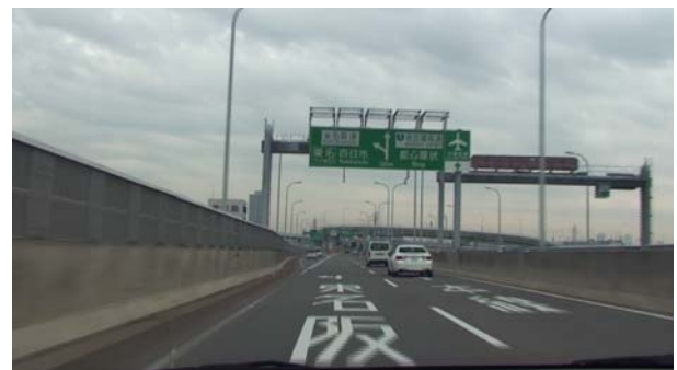
写真-3 単純分岐タイプ標識（200m 手前）
