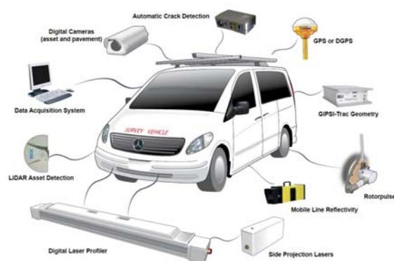
図-1 路面性状測定システムの例
