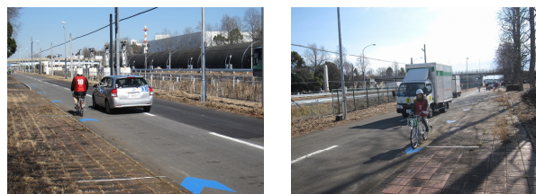
図-2 実験状況（左：小型乗用車による追越し走行時、右：2tトラックによる追越し走行時）
