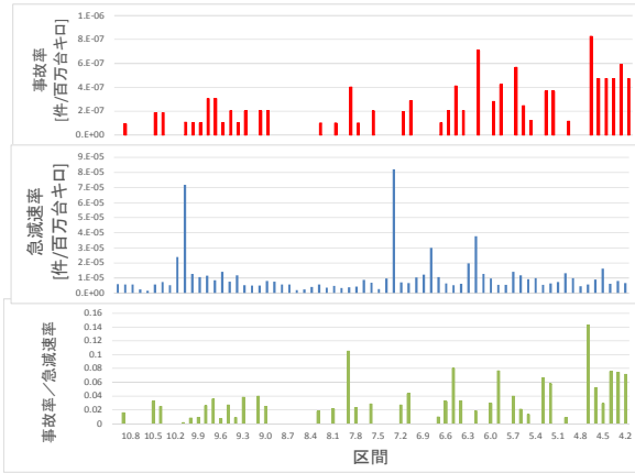
図-3 事故率(上)及び急減速率(下)の100m区間毎の空間変化(4号新宿線乗り)
