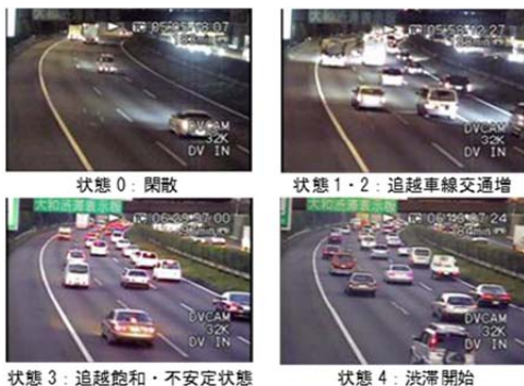
図-8 画像センサによる交通状況把握の例
