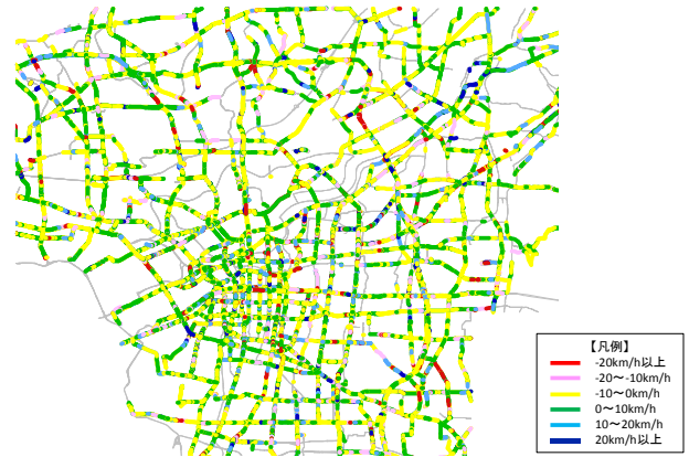
図-8 一般道路の速度差（8時台平均；工事中－工事前）
