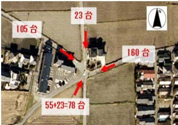
図-3 ピーク時交通量（台/時）写真提供；安曇野市
