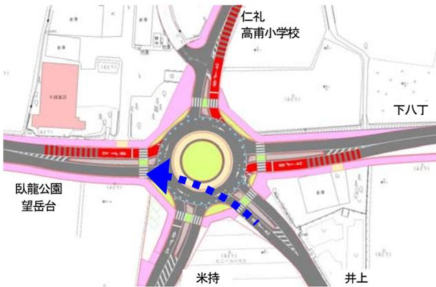
図-13 速度の高い車両動線
