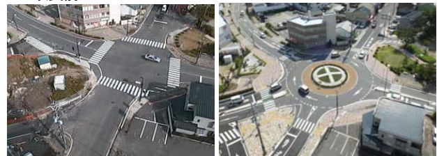
図10 東和町交差点におけるラウンドアバウト化
