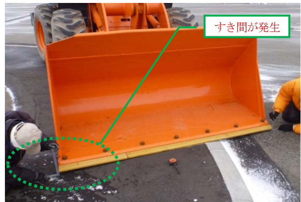
図-7 バケットの接地状況（ホイールローダ）
