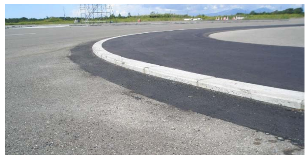
図-2 鉛直部がある模擬エプロン端部（鉛直部の高さ4cm）
