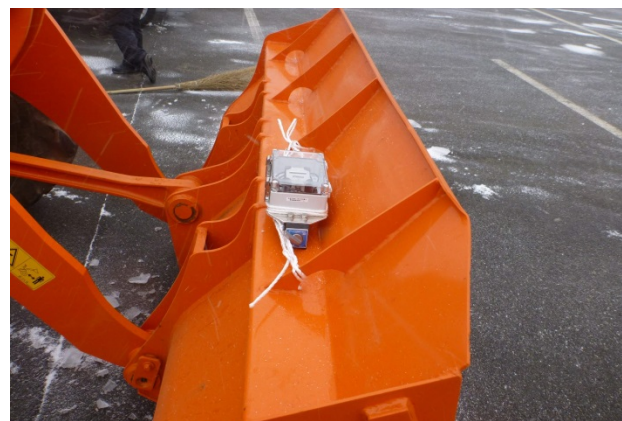
図-12 加速度計の取付状況（ホイールローダ）
