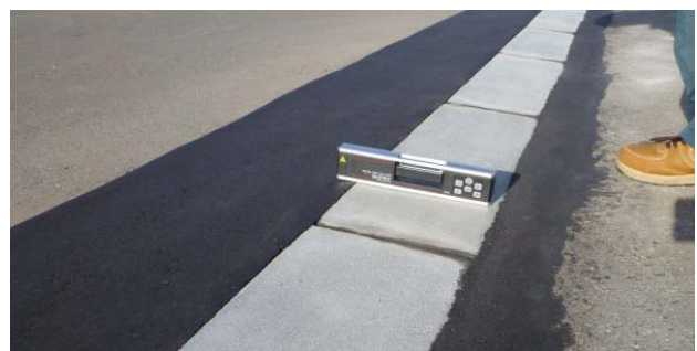
図-3 すりつけ形状の模擬エプロン端部（傾斜角度11°）
