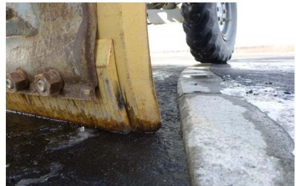
図-16 ブレード接触イメージ（高さ 2cm，モータグレーダ）
