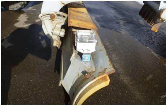
図-13 加速度計の取付状況（モータグレーダ）
